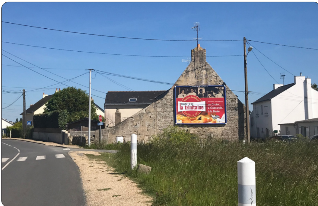
Publicité murale illégale car dépassant la limite d'égout du toit. Mise en conformité possible en réduisant la surface et en respectant les 0,50 m au-dessus du sol.
