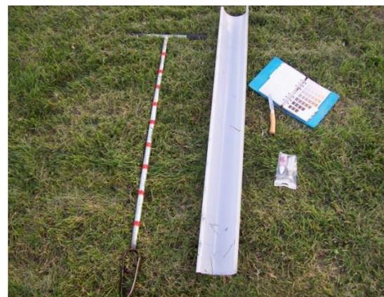
*Matériel utilisé pour le sondage comprenant une tarière à main, une gouttière graduée, une charte Munsell, un couteau, une pissette d'acide et d'eau.*
